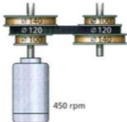
30. Calcula las velocidades de salida que se obtienen en el cono escalonado cuando la velocidad del motor que lo acciona gira a 1300rpm.
